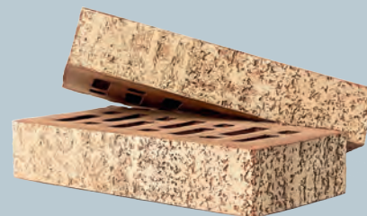
ПОЛНОТЕЛЫЙ 0,8 НФ Кр-л 250x120x50/M200-300/F100 пустотность 10% (пустотелый - 24%)
