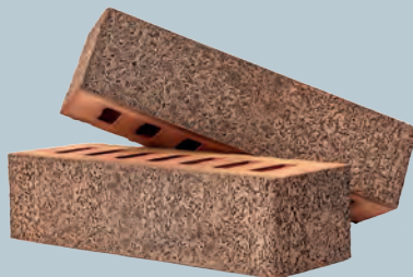
ЕВРО 0,7 НФ Кр-л 250x85x65/М150/Ф100 пустотность 24%
