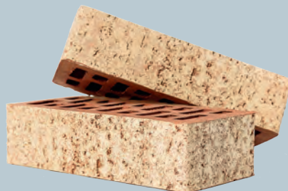
ПУСТОТЕЛЫЙ 1 НФ Кр-л 250x120x65/M150-200/F100 пустотность 36/33/24/28%
