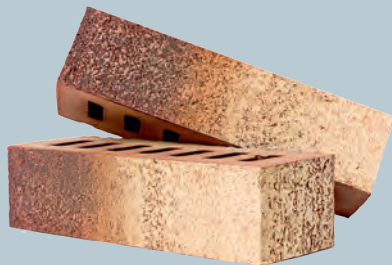
ЕВРО 0,7 НФ Кр-л 250x85x65/М150/Ф100 пустотность 24%
