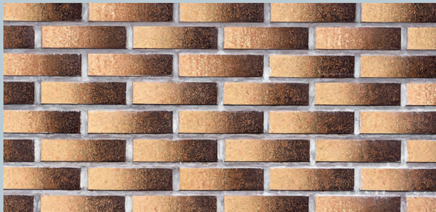
ЕВРО 0,7 НФ Кр-л 250x85x65/М150/Ф100 пустотность 24%
