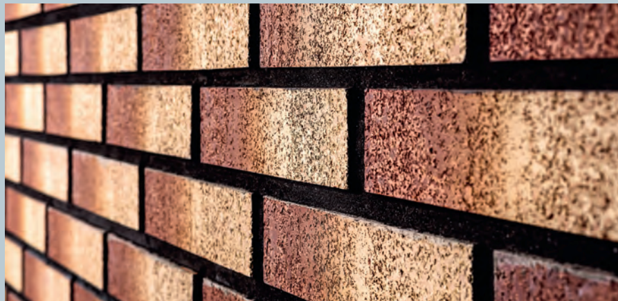
ЕВРО 0,7 НФ Кр-л 250x85x65/М150/Ф100 пустотность 24%
