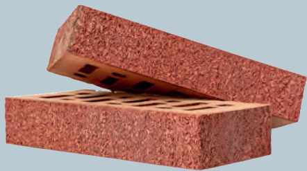
ПОЛНОТЕЛЫЙ 0,8 НФ Кр-л 250x120x50/M200-300/F100 пустотность 10% (пустотелый - 24%)
