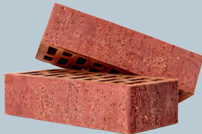
ПУСТОТЕЛЫЙ 1 НФ Кр-л 250x120x65/M150-200/F100 пустотность 36/33/24/28%
