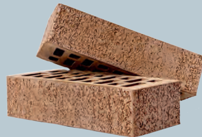
ПУСТОТЕЛЫЙ 1 НФ Кр-л 250x120x65/M150-200/F100 пустотность 36/33/24/28%
