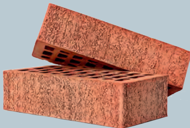
ПУСТОТЕЛЫЙ 1 НФ Кр-л 250x120x65/M150-200/F100 пустотность 36/33/24/28%
