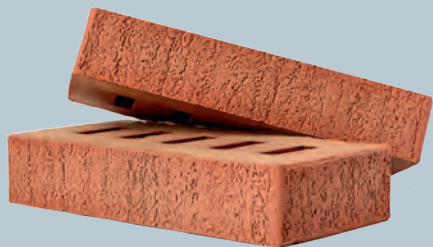
ПОЛНОТЕЛЫЙ 0,8 НФ Кр-л 250x120x50/M200-300/F100 пустотность 10% (пустотелый - 24%)
