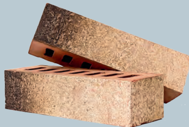
ЕВРО 0,7 НФ Кр-л 250x85x65/М150/Ф100 пустотность 24%
