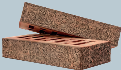
ПУСТОТЕЛЫЙ 0,8 НФ Кр-л 250x120x50/М200-300/Ф100 пустотность 24%
