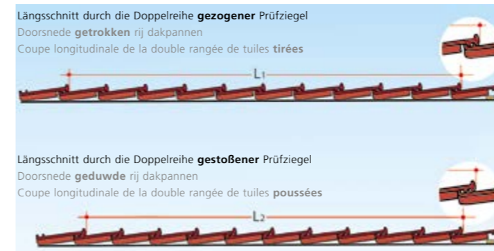
Orientierungs-Decklängen (cm) nach Anzahl der Flächenziegelreihen Latafstand (cm) met he aantal rijen pannen (ter orientatie)
